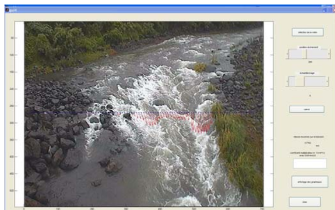
Visualisation des vecteurs de vitesse mesurés à partir de caméras
