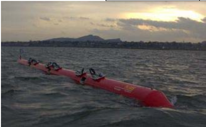
Figure 4.1-23: prototype de Pelamis à l'eau
