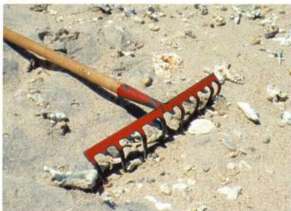
Un râtelier calibré avec des dents espacées de 5 cm
