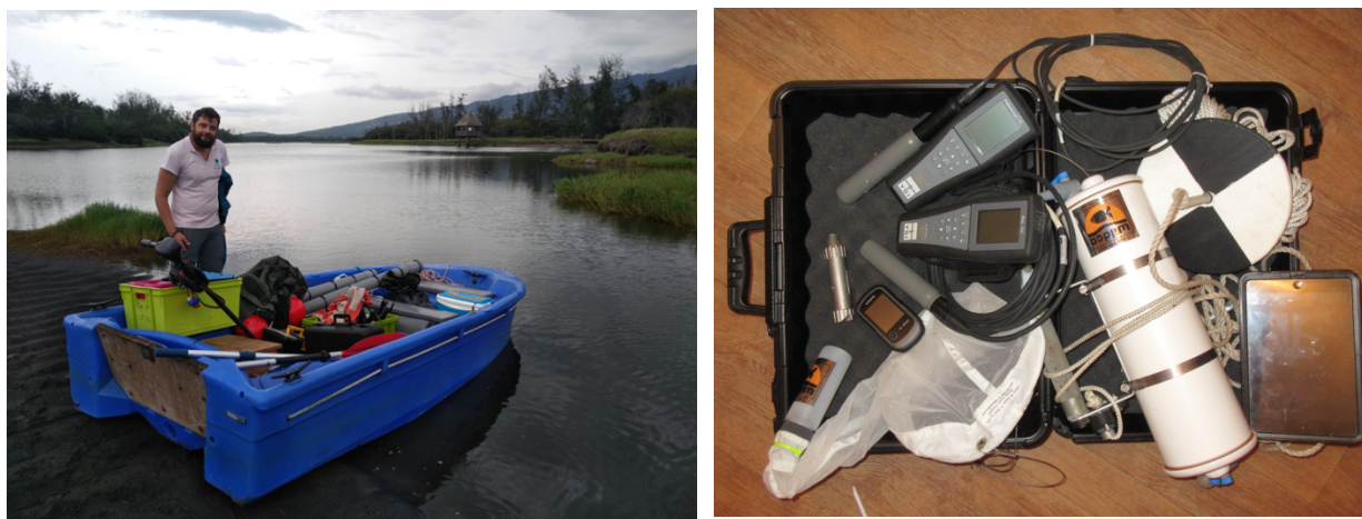
Figure 11 : de gauche à droite, embarcation et matériel lors de la première sortie pour l'installation des stations sur l'Etang du Gol, sondes de mesures, bouteille Van Dorn et disque de secchi...
