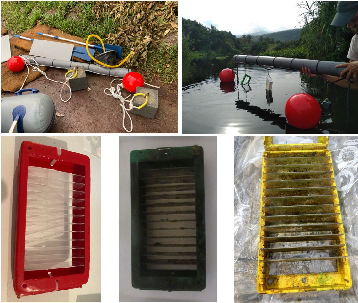
Figure 14 : de gauche à droite et de bas en haut station (tube PVC et bouées) et ses corps morts avant l'installation. Diatomètres fixés à la station. Diatomètre à placer avec lames neuves. Diatomètres avec lames colonisées.
