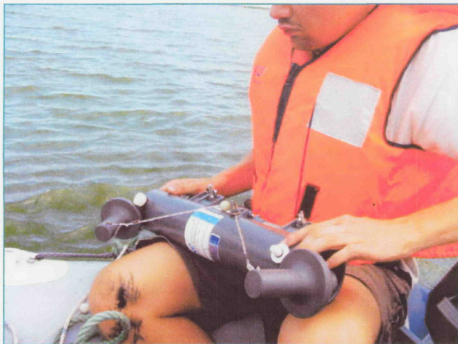
Bouteille de prélèvement utilisée pour les échantillonnages à profondeur donnée
